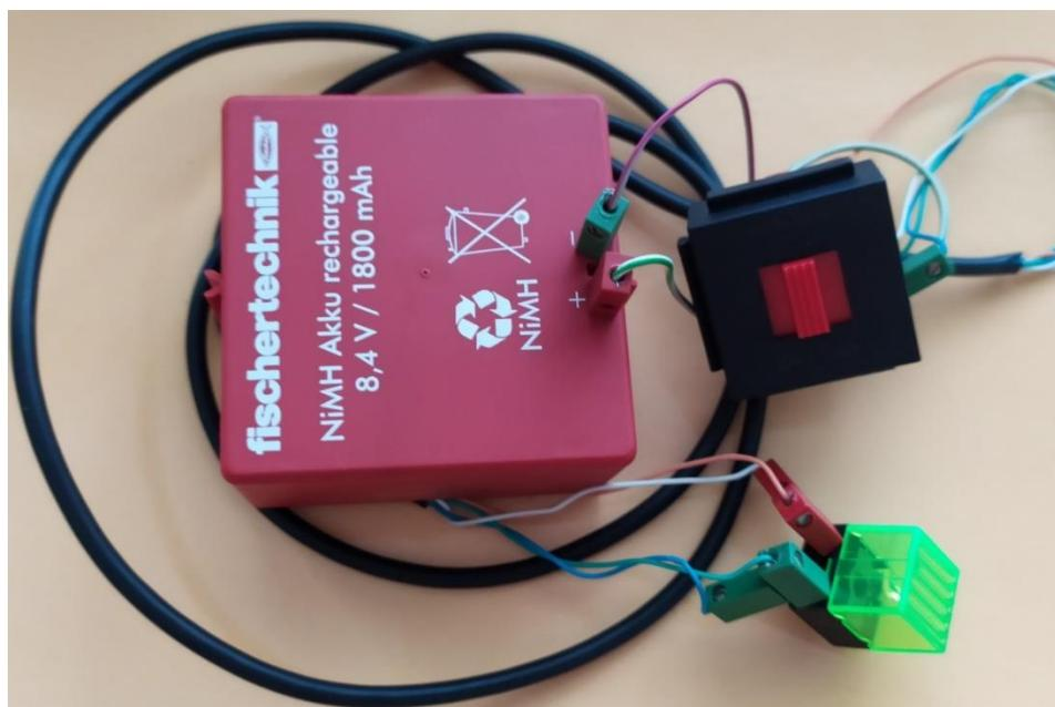
Slika 4. Strujni krug s dvopolnom sklopkom
